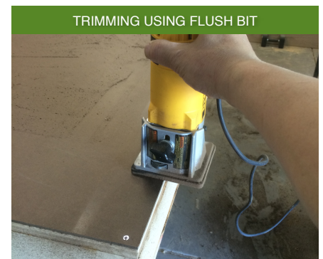
TRIMMING USING FLUSH BIT Tempered Hardboard를 1/8정도 여유있게 Rough Cut하여 Top에 고정한 후, Flush Router Bit를 이용하여 깨끗하게 Trimming한다.
