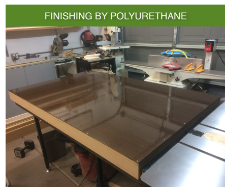
Polyurethane:Mineral Spirit=50:50 혼합하여 4-5회 정도 마감한다. 마지막은 Polyurethane 100%(Satin)로 1회 마감한다.
