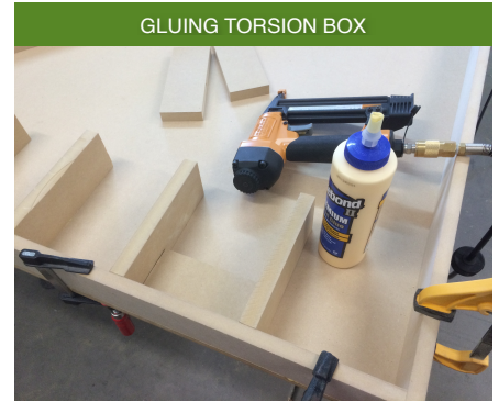
GLUING TORSION BOX Miter Saw에서 일정한 길이로 절단하여 하나씩 Torsion Box를 만들어간다. 중간에 Brad Nail Gun으로 Glue한 후 고정시켜 준다.
