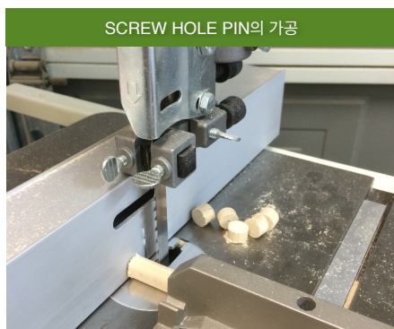
1/2" DOWEL ROD를 BAND SAW로 적당한 크기로 제단한다. 이때 MITER GUAGE를 사용하여 직각으로 절단되도록 한다.
